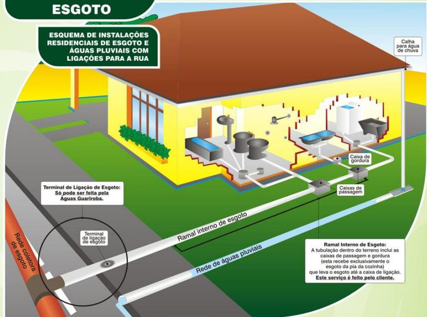
A ligação interna de esgoto (ramal interno) consiste em tubulações que ligam todas as descargas de água do imóvel (exceto as pluviais – da chuva) à rede de esgoto. Portanto, esses canos devem ser ligados às pias, banheiro, tanque e máquina de lavar.
